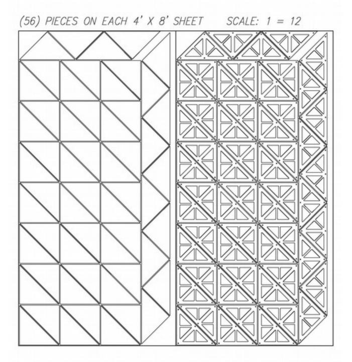
LIGHT RIGHT TRIANGLE GRID UNIT (LRTGU) PROTOTYPE (SINTRA©)
